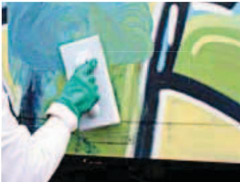
C6 Gel kann zur Graffiti-entfernung auf Fahrzeuglack eingesetzt werden.
